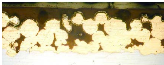
图 12b：腐蚀试验后的金属-聚合物基准轴承
